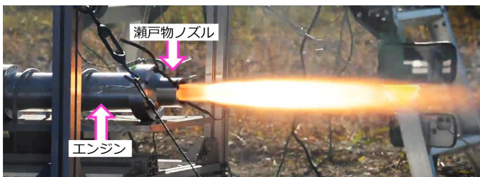
図 2.1 燃焼中の様子（緻密質ノズル）
