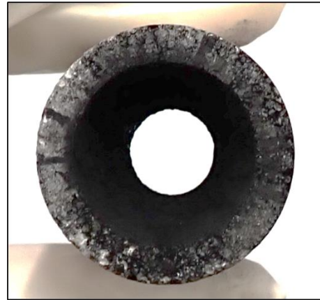
図 2.2 燃焼実験後のノズル（ノズル入口側からの視点）
